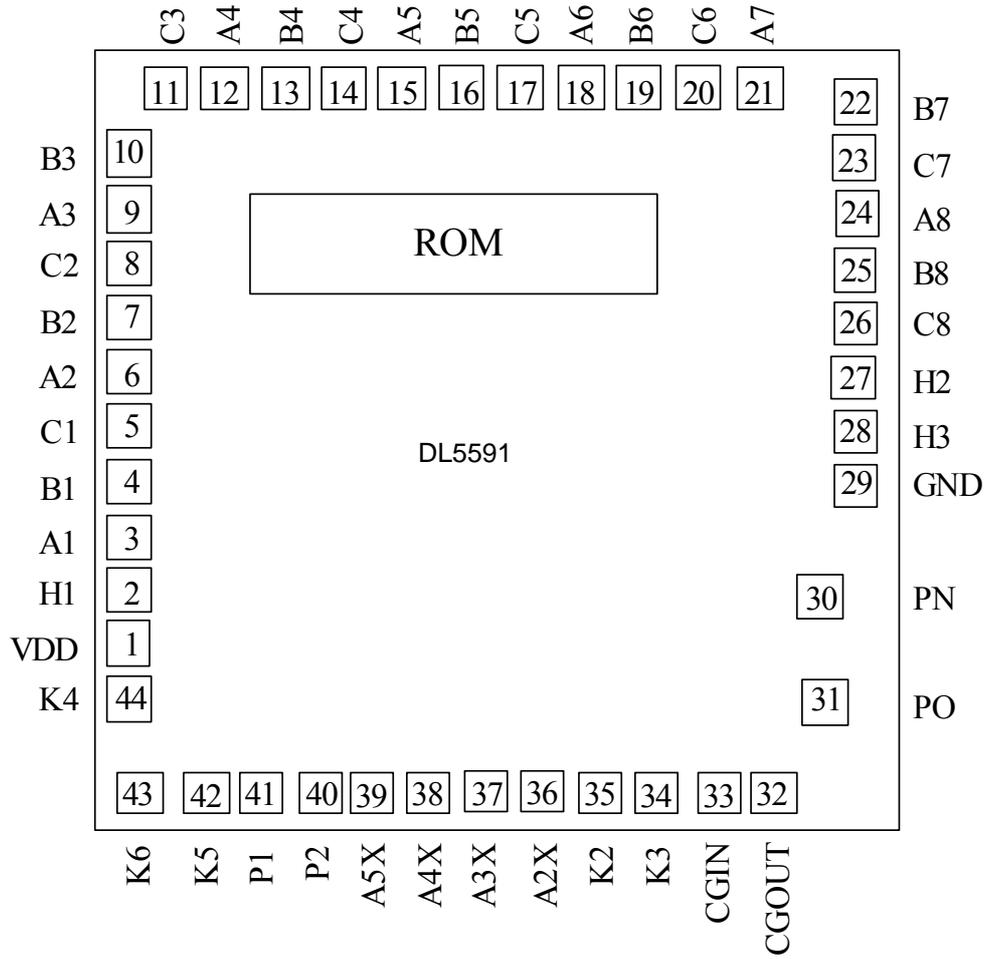
软封示意图 (芯片衬底电位: GND)
